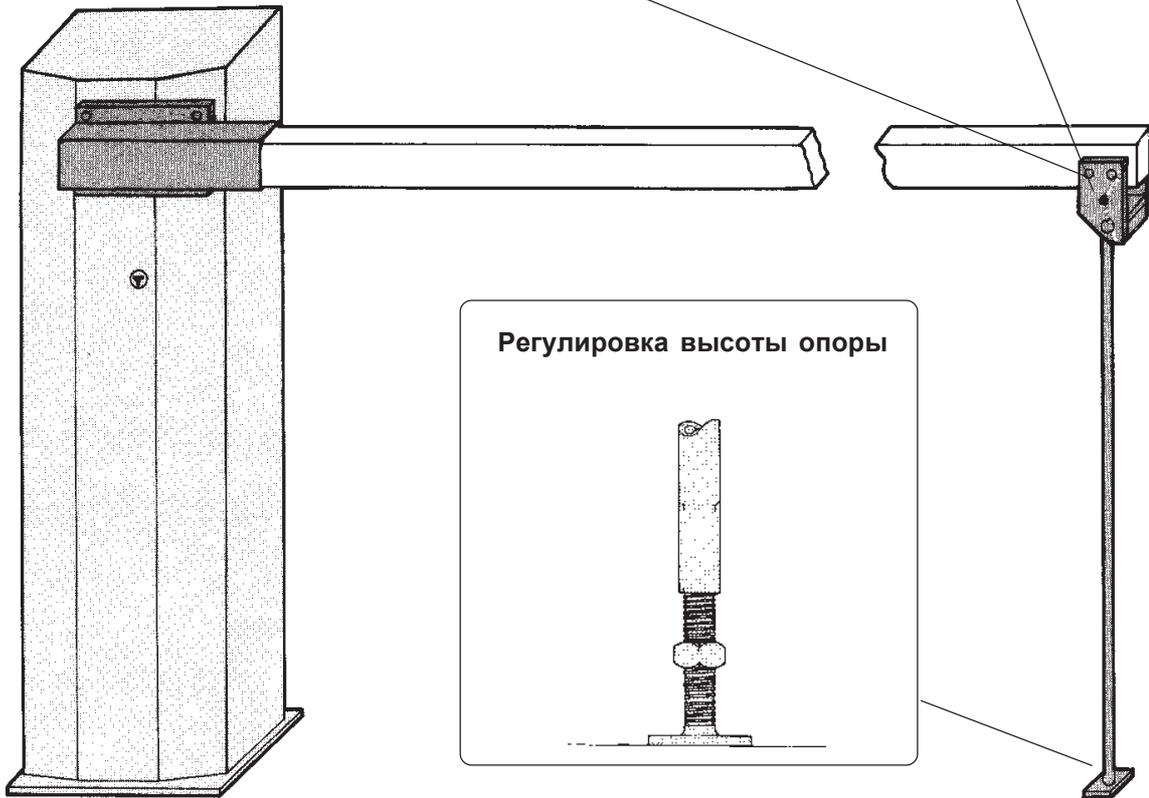
Регулировка высоты опоры
