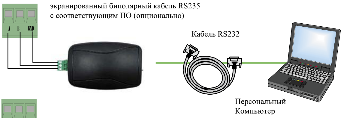
Колодка подключения энкодера (для подключения использовать экранированный кабель 2402C 22AWG)
