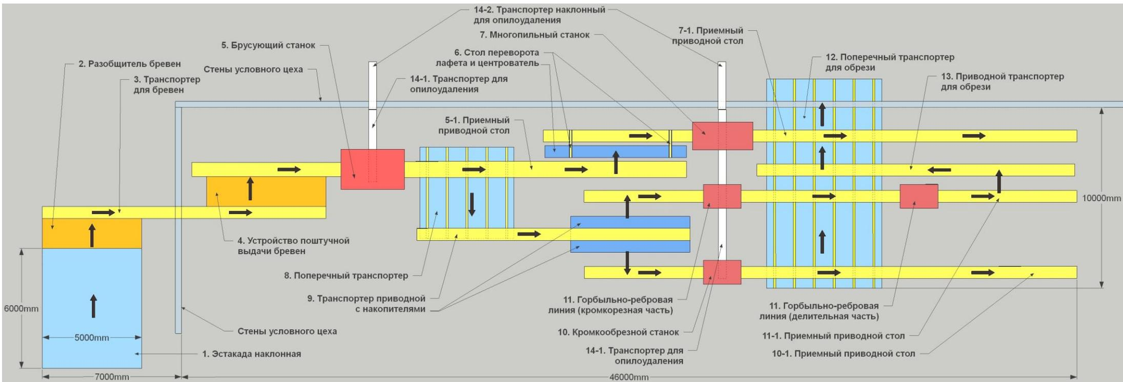
1) Наклонная эстакада, неприводная. Для бревен длиной до 6,5м. Ширина 5м.
