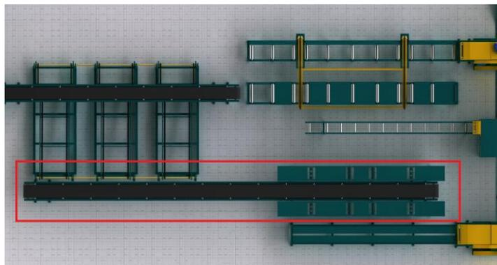
Перемещает необрезную доску и горбыль к подающим столам кромкообрезного и горбыльного станка.
