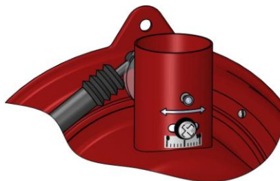
Рис. 12. Регулировка вторичного воздуха одноступенчатой Горелки.
