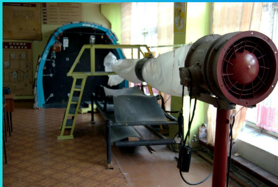
Действующий вентилятор местного проветривания
