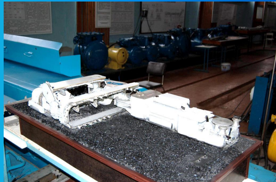
Действующая модель проходческого комбайна Кировец
