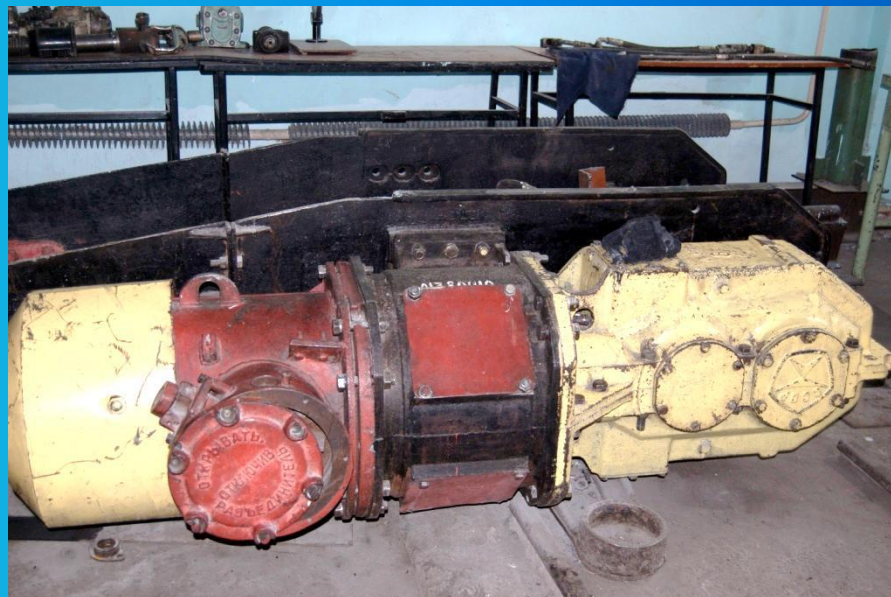
Прводная станция скребкового конвейера СР-70
