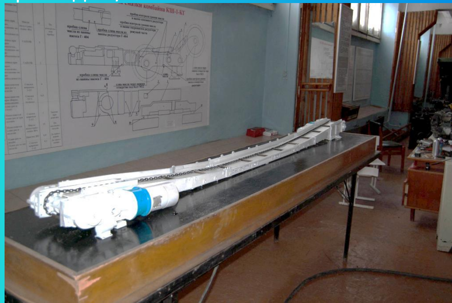
Действующая модель передвижного забойного скребкового конвейера СП63
