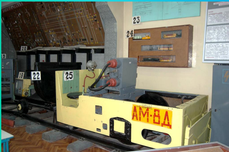
Действующий тренажер аккумуляторного электровоза АМ-8Д
