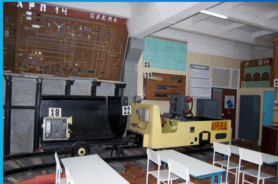
Действующий тренажер аккумуляторного электровоза АМ-8Д
