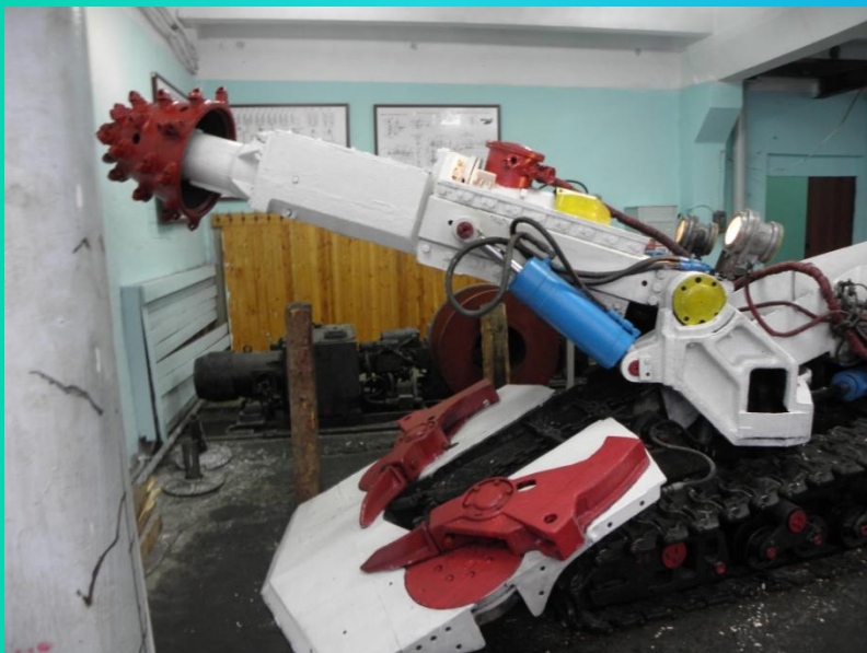
Прходческий комбайн избирательного действия ГПК
