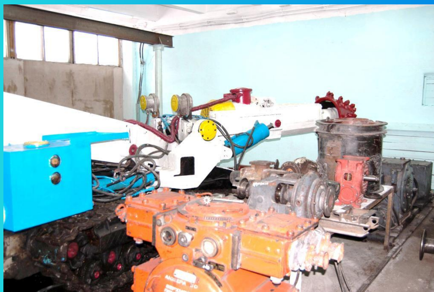
Прходческий комбайн избирательного действия ГПК
