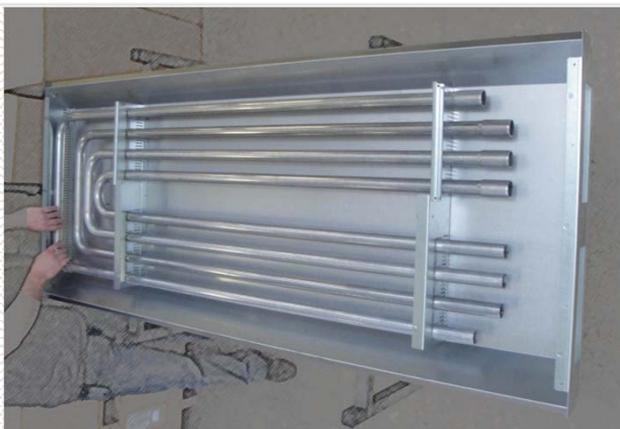
5) Снять на время скобу для фиксации излучающих труб.
