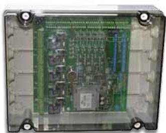
БУФЕР – является системой распределения сигналов управления из щита КТЕ, а также системой питания для отопительных аппаратов LEO и вытяжных вентиляторов. Применение БУФЕРа дает возможность управления макс. 5 аппаратами одновременно при помощи одного щита КТЕ. Установленные в БУФЕРЕ сигнализационные лампочки информируют о степени загрязнения фильтров, о защите от разморозки, а также об аварии вытяжного вентилятора.
