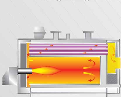
Данная система определяет охлаждение конструктивных элементов котла и уменьшает образование кальциевых отложений во внутренней его части. Овальная форма обечайки предохраняет «жизненно важные» части агрегата от наложения шлама, присутствующего в установке, и обеспечивает, таким образом, достаточный зазор между топкой и самой обечайкой.
