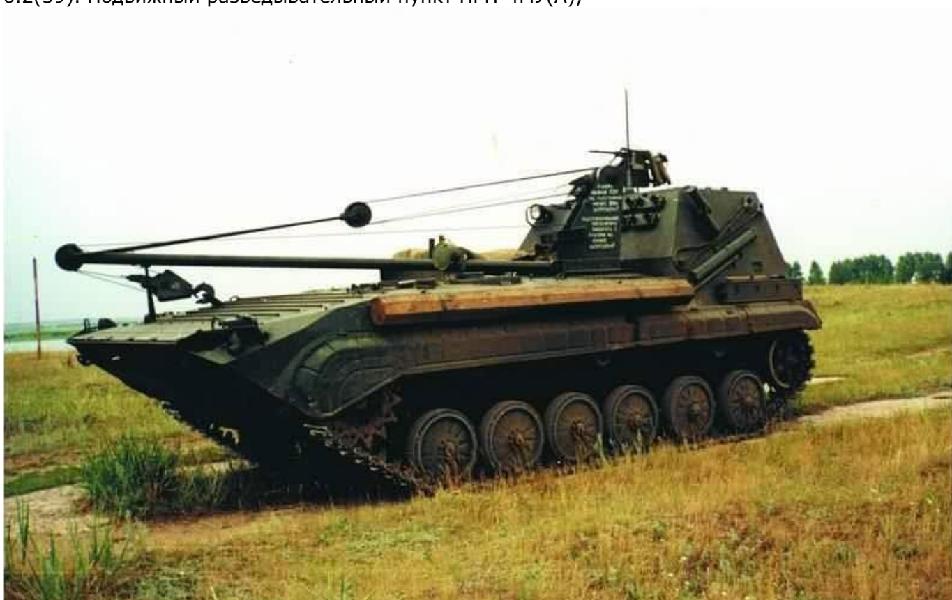
6.3(40). Ремонтная гусеничная машина РМ-Г «Десна»,
