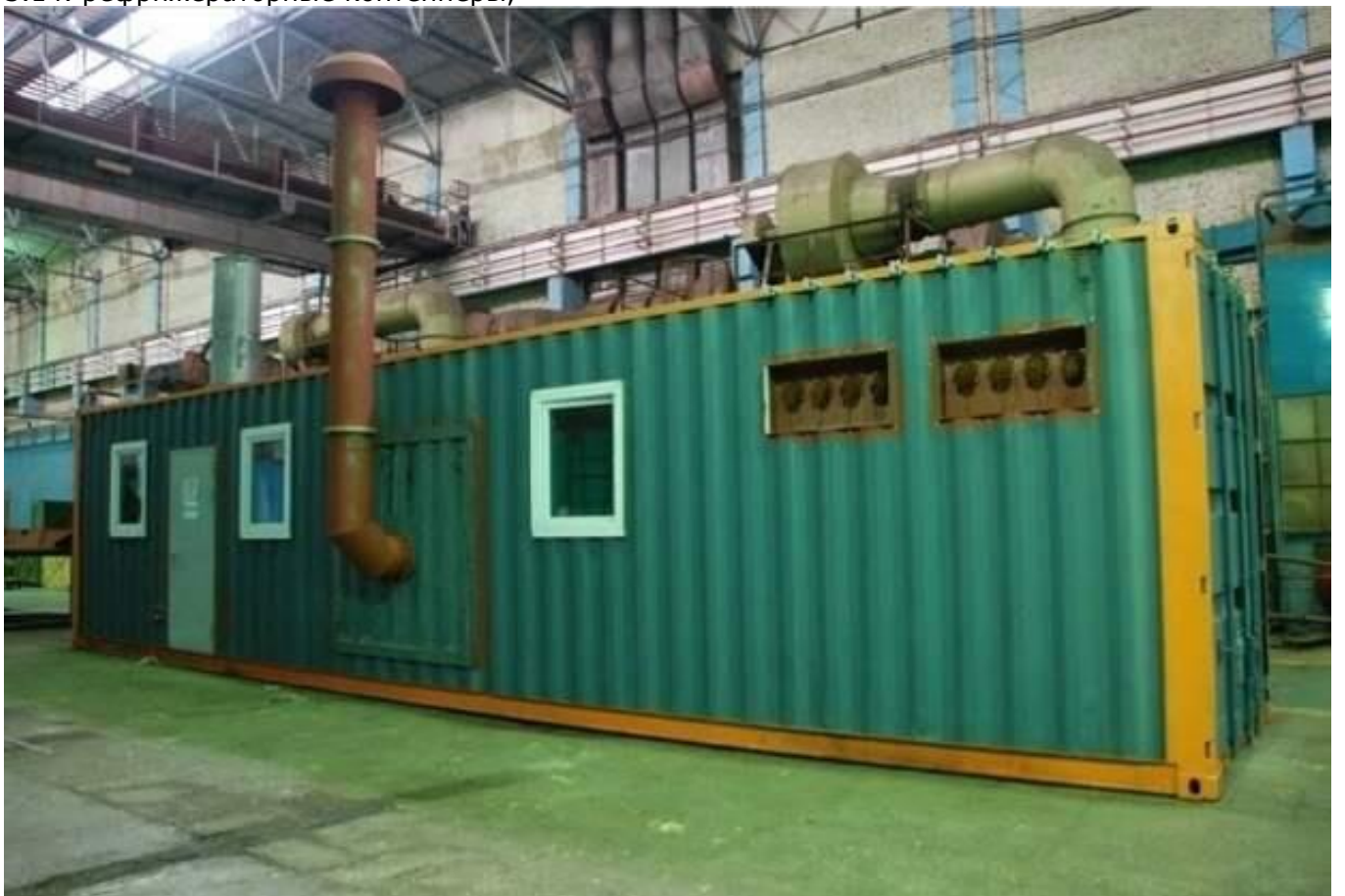
3.15. мини-ТЭЦ «Вулкан» на основе газотурбинного двигателя танка Т-80У,
