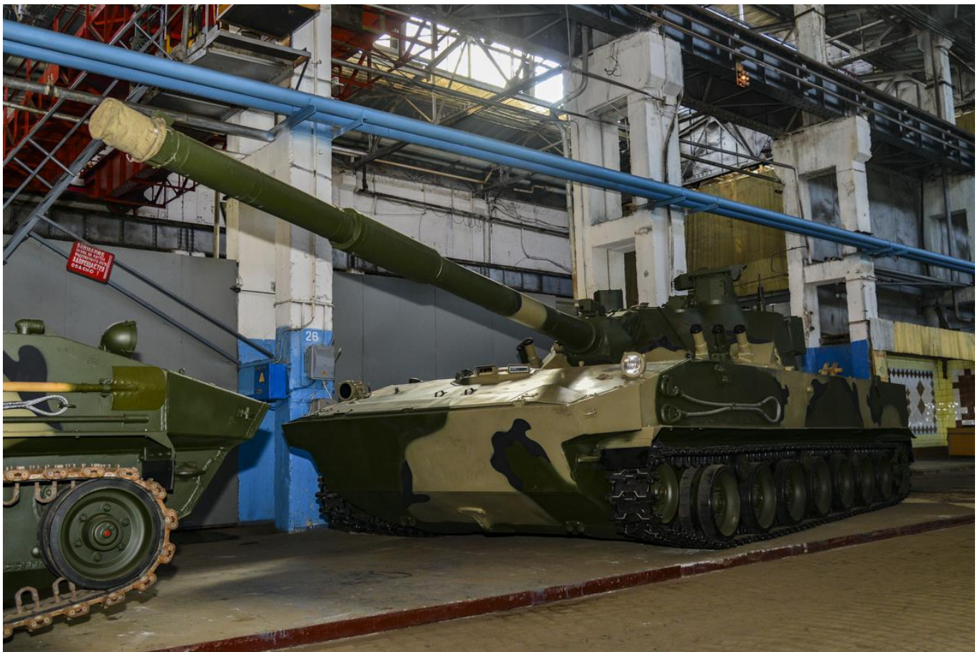
3.3(16). САО "Спрут-СДМ" (125 мм пушка), плавает и десантируется.
