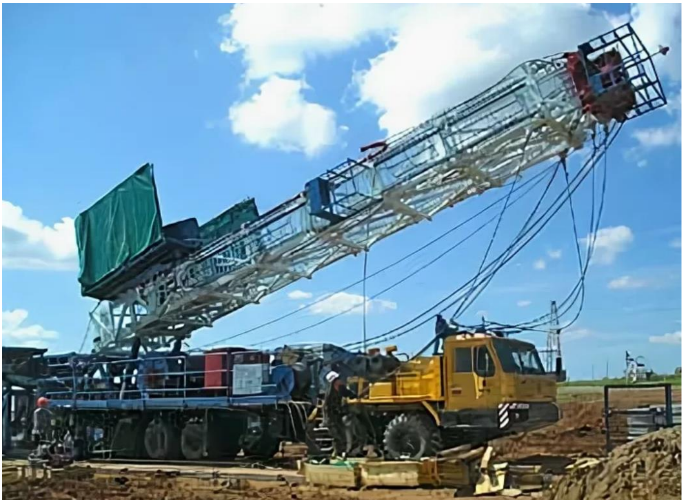
4.17. мобильные буровые установки для ремонта и освоения скважин МБР-125 и МБР-160,
