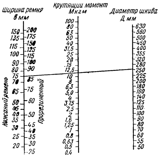
Рис. 107. Номограмма для определения крутящих моментов, передаваемых ремнем на приводной шкив
