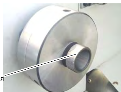
рис.3-5: держатель цангового патрона без соединительной гайки 344 1305 without union nut.
