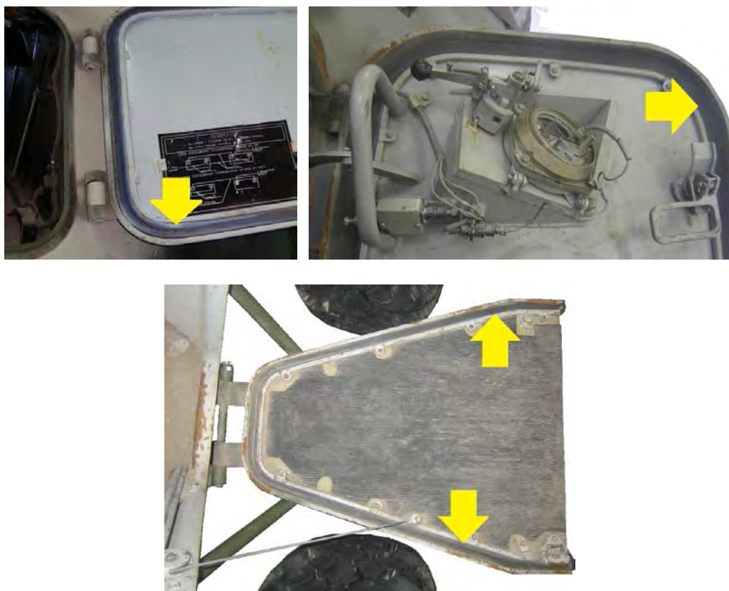
Рисунок 5.27 – Проверка состояния резиновых уплотнителей крышек люков
