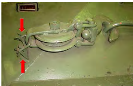
Рисунок 4.21 – Проверка надежность крепления ЗИП снаружи машины
