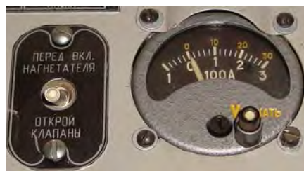
Рисунок 4.13 – Показания вольтамперметра ( I_p = 0 А) при исправной генераторной установке
