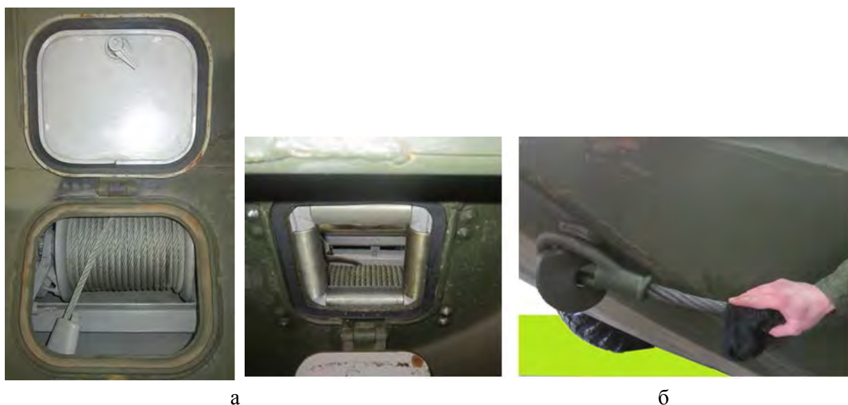
Рисунок 5.24 – Обслуживание тросов лебедки и буксирного
