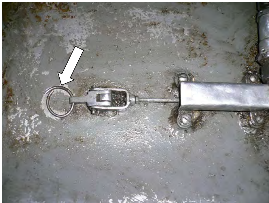
Рисунок 4.32 – Управляемый клапан для обеспечения перетекания воды из среднего в моторно-трансмиссионное отделение
