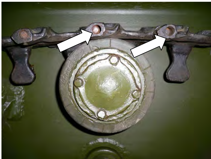
Рисунок – 5.6 Проверить состояние траков и пальцев гусениц, а также наличие пробок стопорных пальцев
