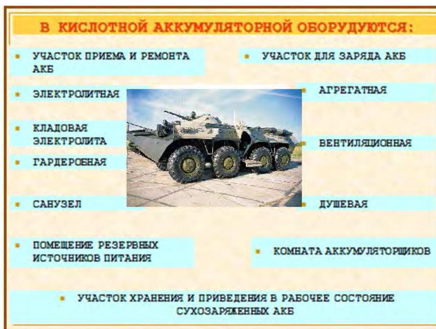
Рисунок 3.28 – Участки и помещения кислотной аккумуляторной
