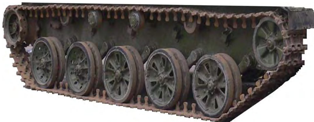
Рисунок 4.20 – Натяжение гусениц с усилием 400 кгс
