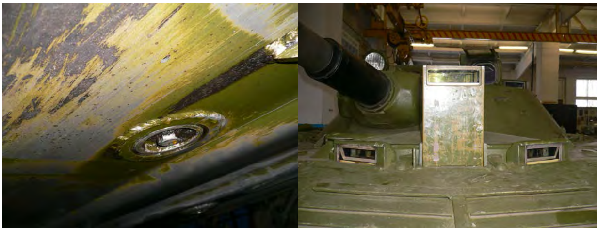
Рисунок 4.40 – Сливные отверстия на днище машины для удаления воды. Обслуживание смотровых приборов после преодоления водной преграды
