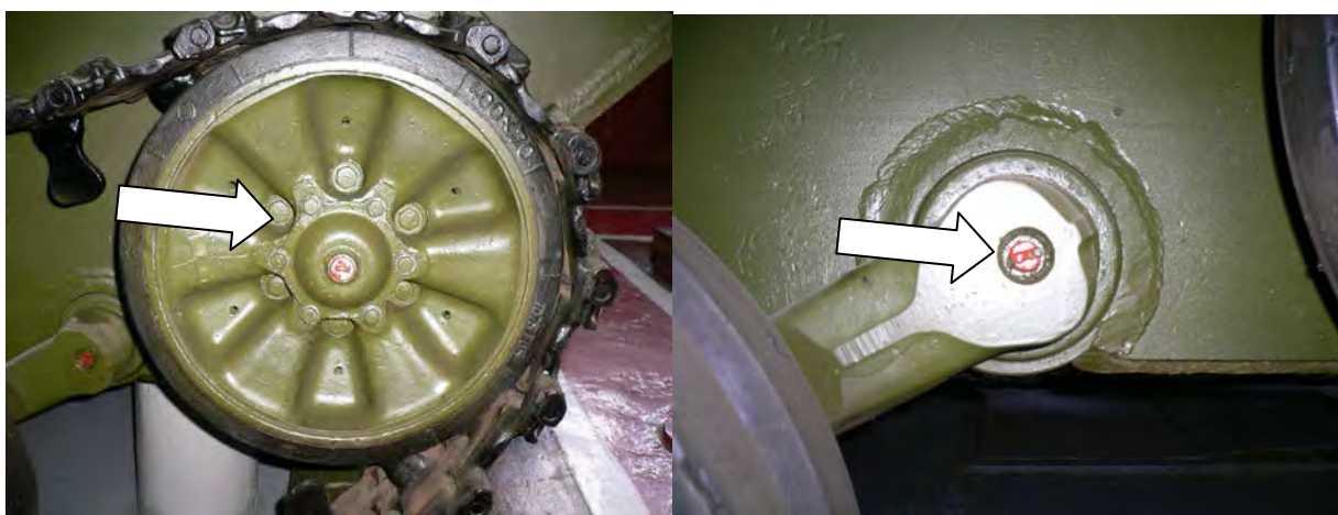
Рисунок 5.7 (а) – Проверка состояния опорных катков, направляющих колес, поддерживающих катков, упоров балансиров и их смазка
