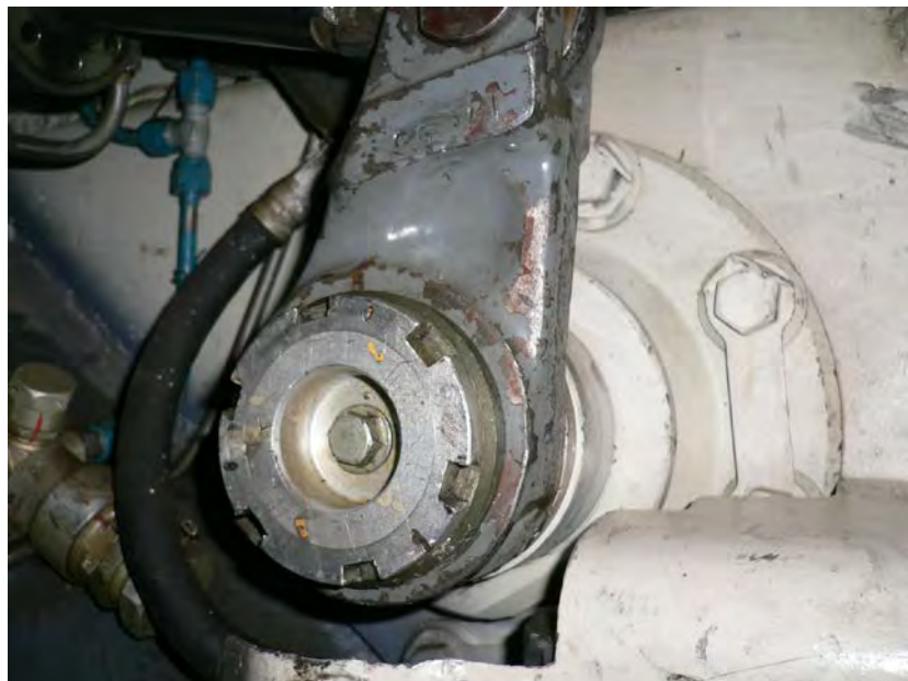
Рисунок 4.24 - Кривошип механизма натяжения гусеницы
