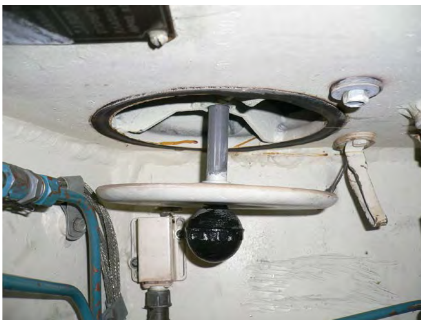
Рисунок 5.20 – Механизм открывания и закрывания клапанов воздухозаборника двигателя
