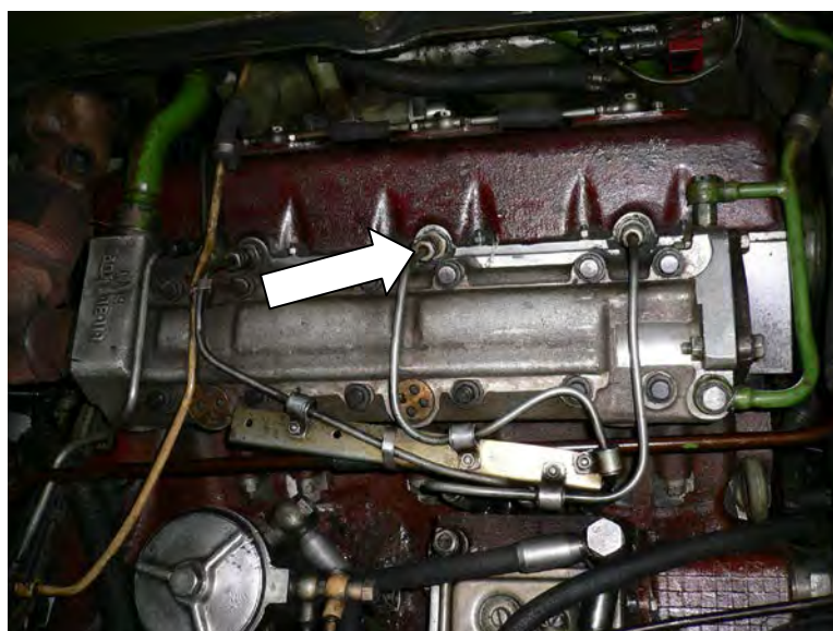
Рисунок 5.10 – Двигатель БМД-2 (БТР-Д) без течи из систем питания и смазывания
