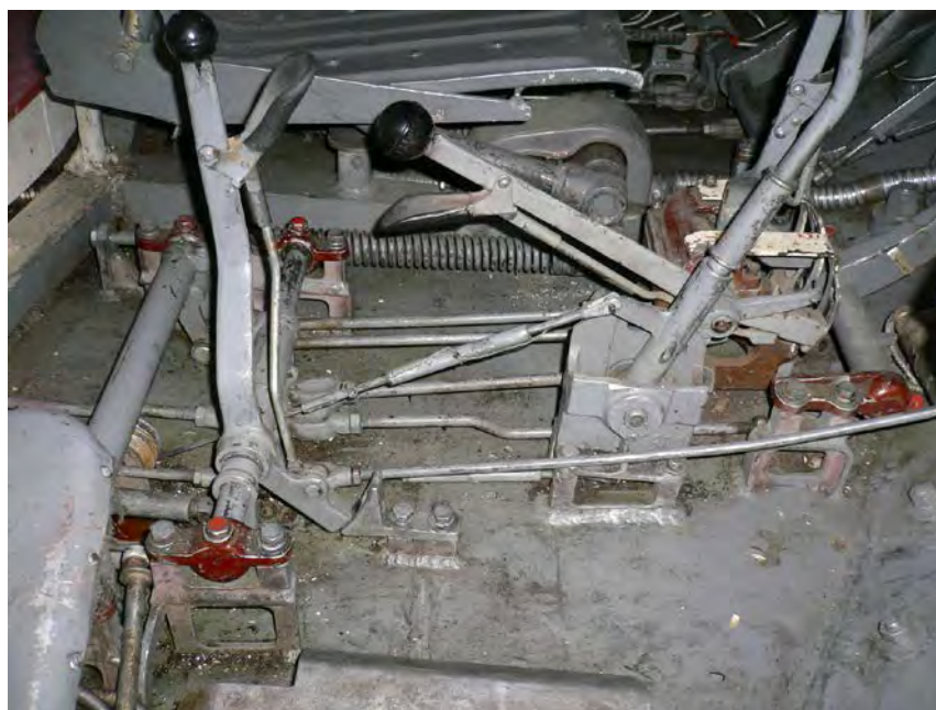
Рисунок 4.15 – Приводы управления коробкой передач, главным фрикционом, бортовыми фрикционами механизма поворота и тормозами
