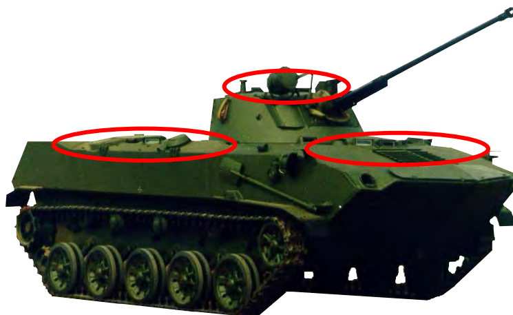
Рисунок 5.3 – Мойка БМД-2 (БТР-Д), очистка от грязи, проверка корпуса машины на наличие повреждений
