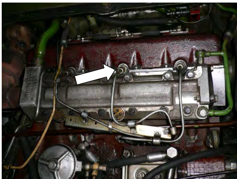
Рисунок 4.8 – Двигатель БМД-2 без течи из систем питания и смазывания
