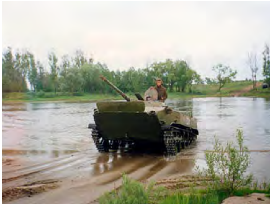
Рисунок 4.39 – Проверка на плаву герметичности корпуса машины
