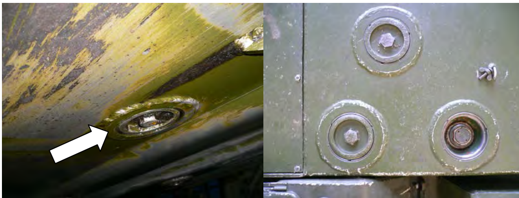
Рисунок 5.4 – Проверка наличия и плотности затяжки всех крышек люков и пробок корпуса машины и башни
