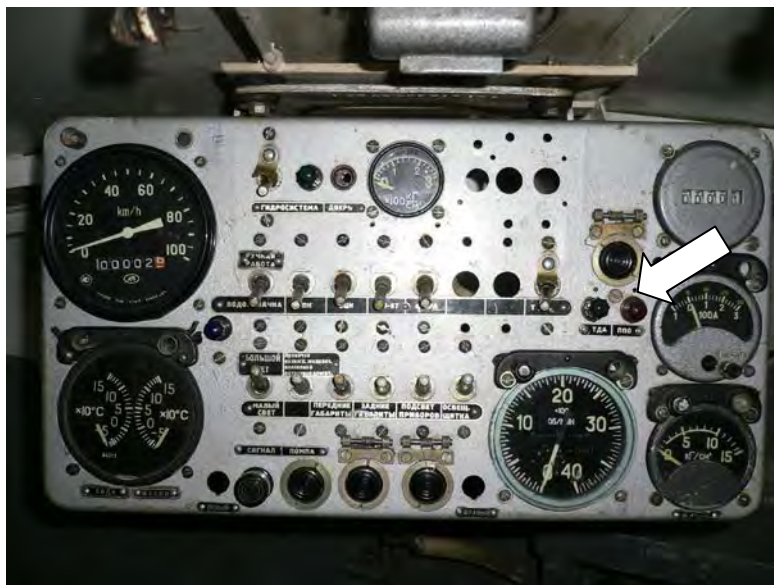
Рисунок 5.34 – Сигнальный фонарь контроля исправности системы ППО
