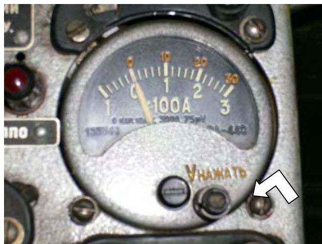
Рисунок 4.16 – Вольтамперметр на центральном щитке приборов механика-водителя (верхняя шкала – для измерения напряжения, нижняя шкала – для измерения силы тока)
