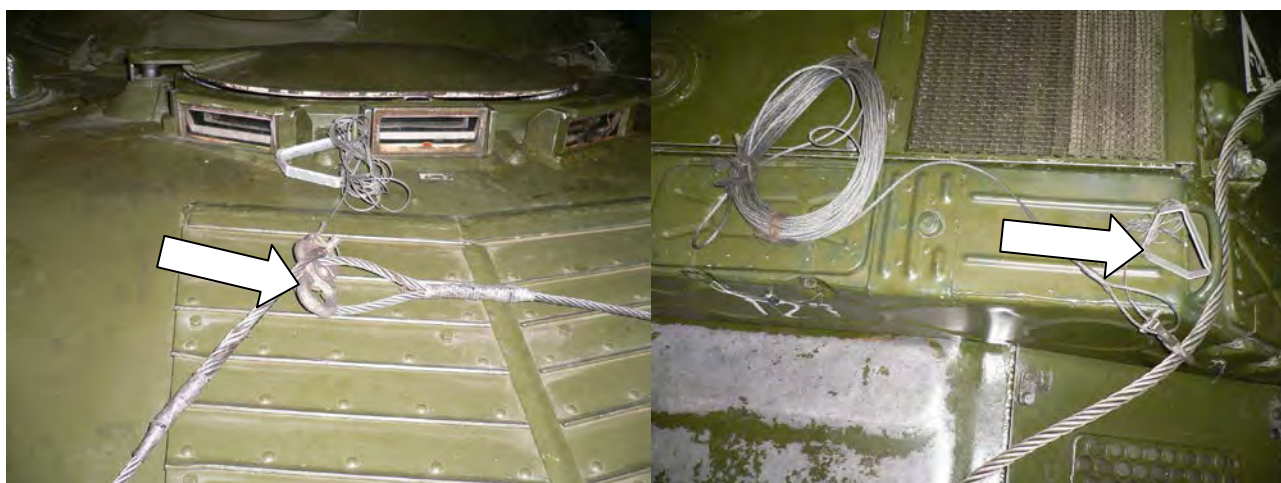
Рисунок 4.35 – Укладка и закрепление буксирного троса на машине (впереди и сзади) при преодолении водной преграды
