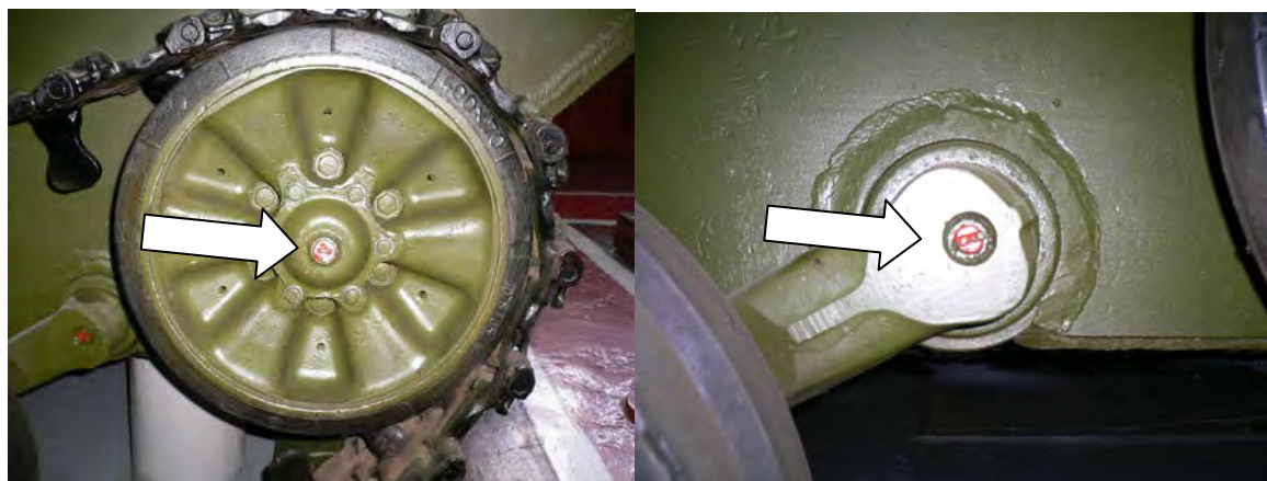
Рисунок 4.38 – Элементы ходовой части БМД-2 (БТР-Д), подлежащие дозаправке смазки перед преодолением водной преграды
