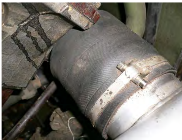
Рисунок 5.14 – Шланг, соединяющий раздаточную трубу с впускными коллекторами двигателя
