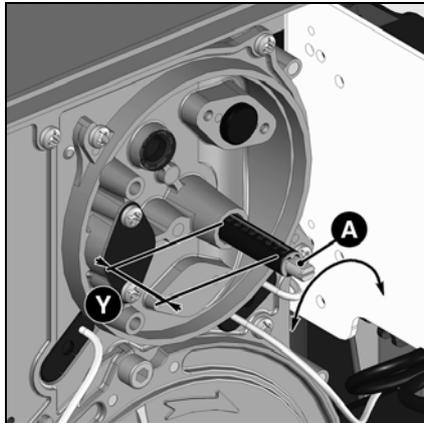
Помимо изменения подачи воздуха, **регулирование воздуха в головкегорелки** влияет также на зону смешивания и давление воздуха в трубке горелки. Поверните винт **A**:
