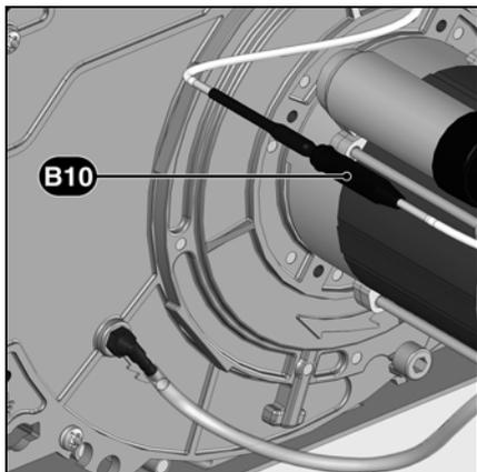
предохранительный термоклапан (устанавливается клиентом).
