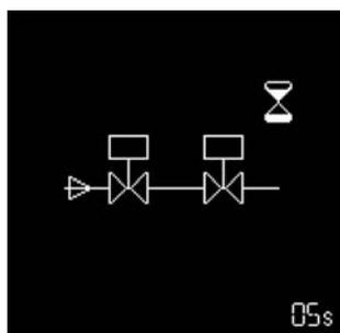
Проверка герметичности газовых клапанов\* (оставшееся время отображается в правом нижнем углу меню)
